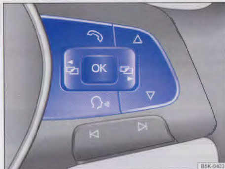
Rys. 67 Prawa strona kierownicy wielofunkcyjnej: przyciski dla obsługi dla menu i wskazań informacji w zestawie wskaźników
