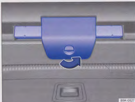
Rys. 96 W pokrywie bagażnika: otworzyć uchwyt trójkąta ostrzegawczego (Variant).
