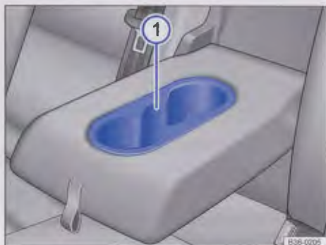
Rys. 218 Podłokietnik z tyłu: Uchwyt pojemnika do napoju
