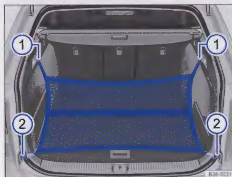
Rys. 248 W przestrzeni bagażnika: siatka do bagażu zawieszona na krawędzi ładunkowej
