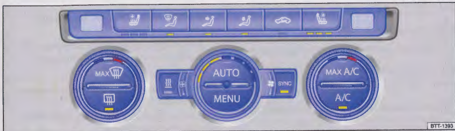
Rys. 133 W górnej części konsoli środkowej: elementy obsługi klimatyzacji Climatronic
