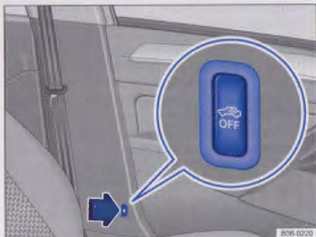
Rys. 80 Obok siedzenia kierowcy: przycisk wyłączenia systemu kontroli wnętrza i zabezpieczenia holowania
