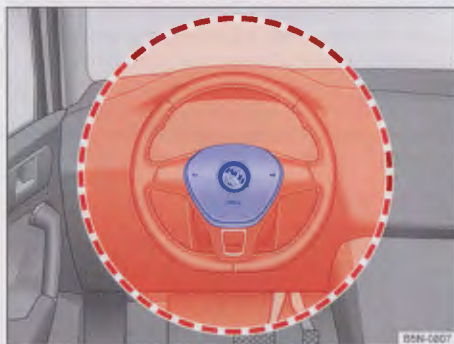
Rys. 15 Usytuowanie i strefa napełnienia się przedniej poduszki bezpieczeństwa kierowcy
