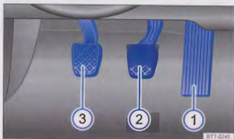
Rys. 140 Pedale w samochodzie z przekładnią ręczną: ① pedał przyspieszenia, ② pedał hamulca, ③ pedał sprzęgła
