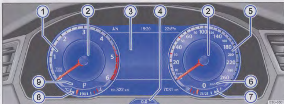
Rys. 56 Wyświetlacz Active Info w tablicy przyrządów
