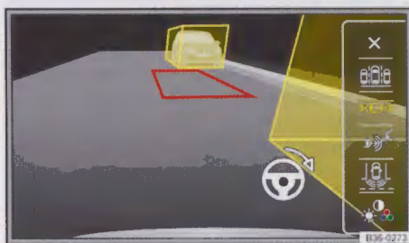
Rys. 194 Wskazanie ekranu kamery wstecznej: włączony tryb 2
