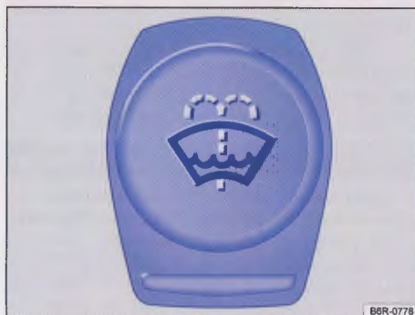
Rys. 297 W przedziale silnikowym: pokrywa zbiornika płynu do mycia szyb
