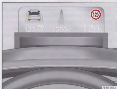
Rys. 58 W tablicy przyrządów powyżej kierownicy: przykładowe wskazania na wyświetlaczu Head-up.
