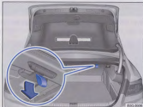
Rys. 254 W przestrzeni bagażnika: wieszak do toreb
