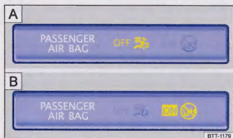
Rys. 14 W górnej części konsoli środkowej: lampka kontrolna dla wyłączonej przedniej poduszki bezpieczeństwa pasażera A , albo lampka kontrolna dla włączonej przedniej poduszki bezpieczeństwa pasażera B .
