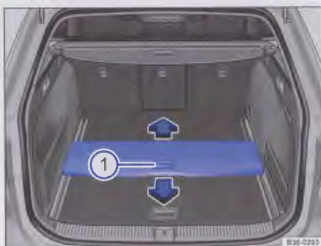
Rys. 237 W przestrzeni bagażnika: przesuwana podłoga bagażnika
