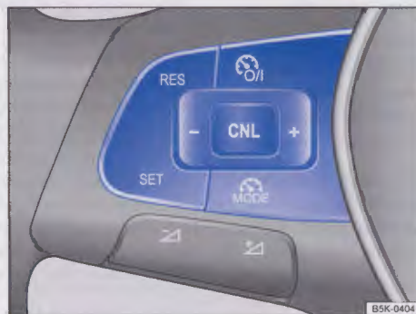
Rys. 165 Lewa strona kierownicy wielofunkcyjnej: przyciski dla obsługi ogranicznika prędkości jazdy ▶
