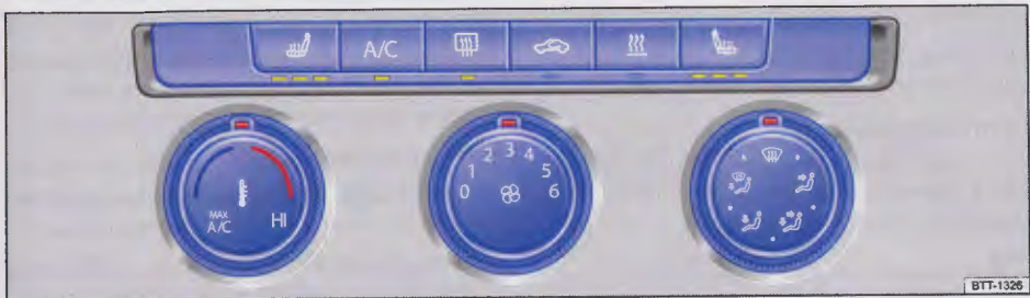
Rys. 132 W górnej części konsoli środkowej: elementy obsługi ręcznego układu klimatyzacji lub systemu ogrzewania i nawiewu świeżego powietrza.
