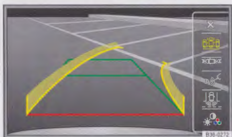
Rys. 193 Wskazanie ekranu kamery wstecznej: włączony tryb 1
