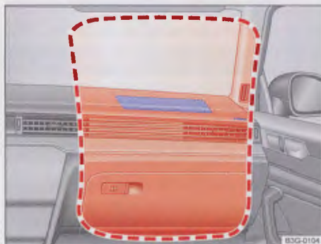
Rys. 16 Usytuowanie i strefa napełnienia się poduszki bezpieczeństwa pasażera
