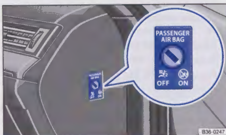
Rys. 17 Po stronie pasażera w tablicy przyrządów: wyłącznik na kluczyk do włączania i wyłączania przedniej poduszki bezpieczeństwa
