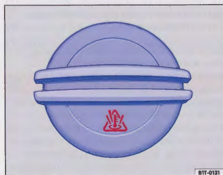
Rys. 301 W przedziale silnikowym: pokrywa zbiornika wyrównawczego płynu chłodzącego silnik
