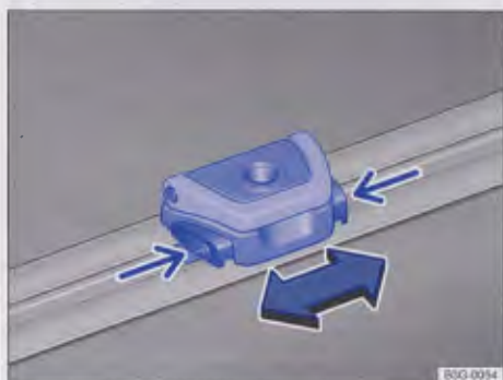
Rys. 251 W przestrzeni bagażnika: regulowanie i wymontowanie zaczepek do wiązania
