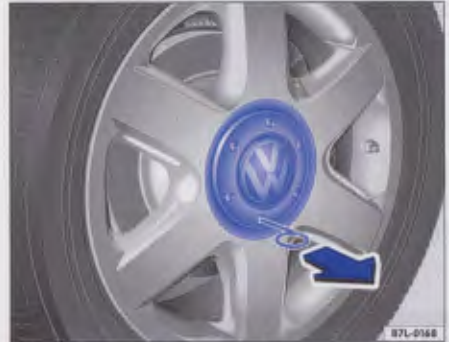
Rys. 313 Zdejmowanie osłony piasty koła
