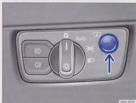
Rys. 57 Obok kierownicy: pokrętko regulacji wyświetlacza Head-up (strzałką).
