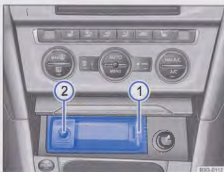
Rys. 220 W konsoli środkowej z przodu: wyjmowanie popielniczki ① i gaszenia żaru ②.
