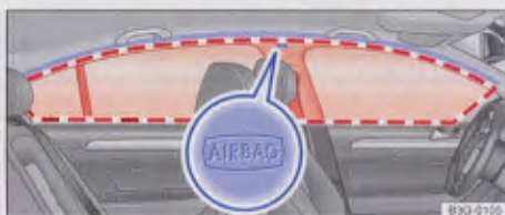
Rys. 20 Z lewej strony samochodu (Limousine): usytuowanie i strefa napełniania się poduszek bezpieczeństwa głowy
