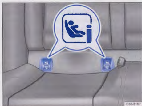
Rys. 27 Przy siedzeniu kierowcy: oznakowanie punktów zakotwiczenia ISOFIX fotelika dla dziecka
