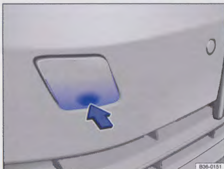
Rys. 292 W przednim zderzaku z prawej strony: zdejmowanie pokrywy
