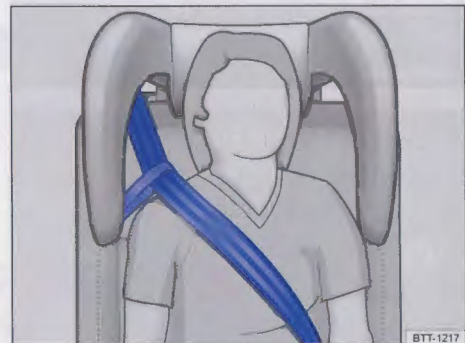
Rys. 34 Zintegrowany fotelik dla dziecka: ułożenie pasa z uchem prowadnicy
