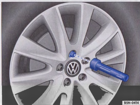
Rys. 321 Zmiana koła: wykręcanie śrub koła uchwytem wkrętaka
