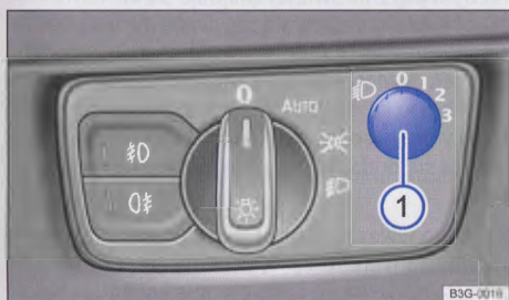
Rys. 119 Obok kierownicy: pokrętko regulacji zasięgu światła ①
