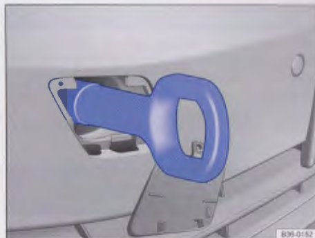
Rys. 293 W zderzaku z przodu z prawej strony: wkręcone ucho holownicze
