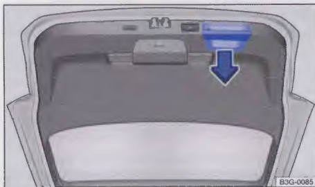
Rys. 93 Otwarta pokrywa bagażnika: uchwyt do domykania (Variant).
