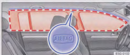
Rys. 21 Z lewej strony samochodu (Wariant): usytuowanie i strefa napełniania się poduszek bezpieczeństwa głowy
