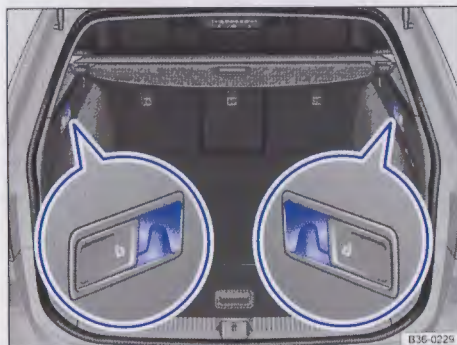
Rys. 256 W przestrzeni bagażnika: wieszak do toreb z tyłu
