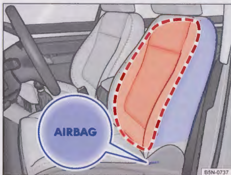
Rys. 19 Z boku w przednim siedzeniu: usytuowanie i strefa napełnienia się bocznej poduszki bezpieczeństwa
