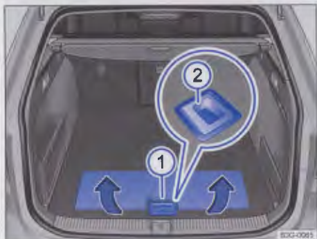
Rys. 235 W przestrzeni bagażnika: dzielona podłoga bagażnika
