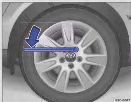
Rys. 317 Zmiana koła: luzowanie śrub koła
