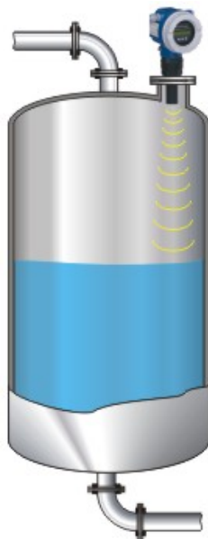
Rysunek 2.2 Pomiar ultradźwiękowy [1]
