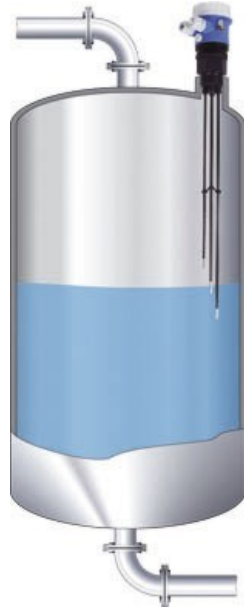
Rysunek 2.5 Pomiar przewodnościowy [1]
